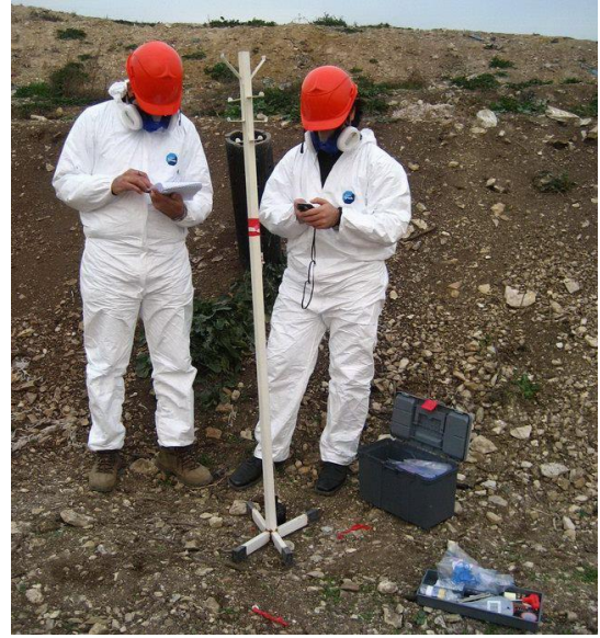
Şekil 1. Lot 5'te bir deponi gazı çıkış bacasında örnekleme ve GPS koordinatlarının belirlenmesi.
